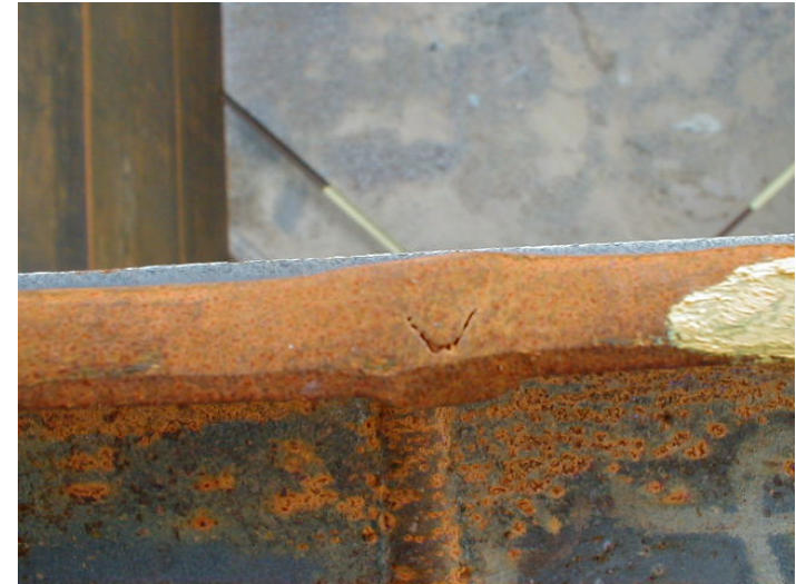
Mancanza di penetrazione, incollatura
