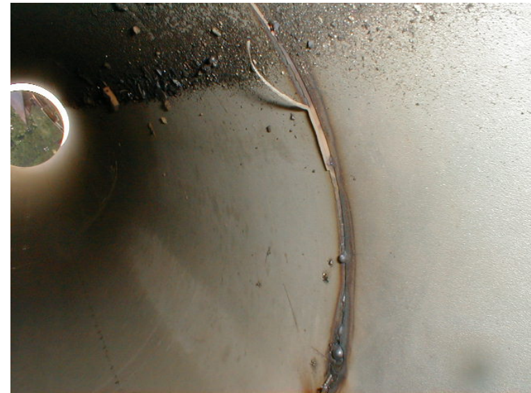
Superficie ricoperta con calamina (Assenza di protezione al rovescio)
