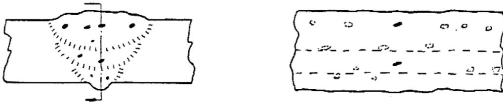
porosità a grappolo: consistono in una concentrazione di porosità che sono localizzate in una regione separata dal resto della saldatura.
